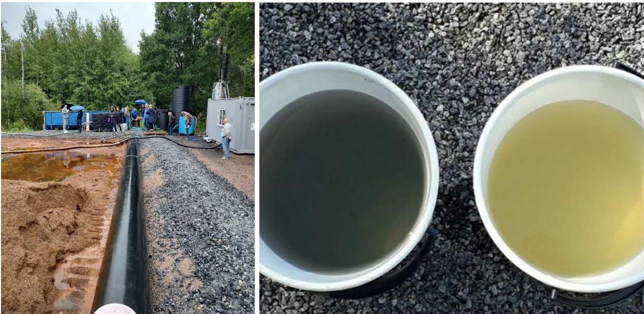
Kuva 10. Vasemmalla tutkijat esittelemässä Kymijärven alusveden suodatuslaitteistoa ja rakenteita kansainvälisille vieraille 29.8.2022. Oikealla kuvapari, joista ensimmäisessä sangossa Kymijärven käsittelemätöntä alusvettä. Toisessa sangossa ilmastuksella ja suodatuksella käsiteltyä vettä.
