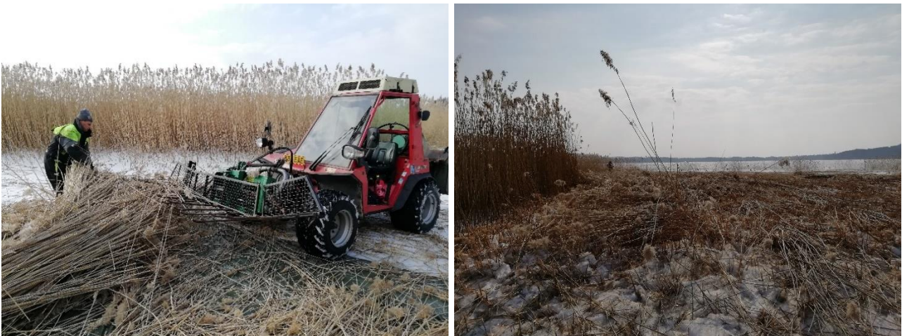
Kuva 11. Koneellista niittoa kokeiltiin Vähäselällä, mutta jää ruovikossa ei kantanut konetta ja työtä jouduttiin jatkamaan raivaussahalla.
