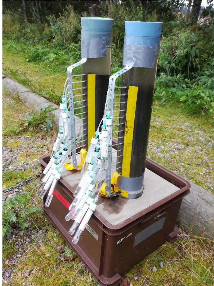
Kuva 2. Huokosvesinäytteenotto sedimentistä Rhizon-menetelmällä vakuumputkia hyödyntäen.
