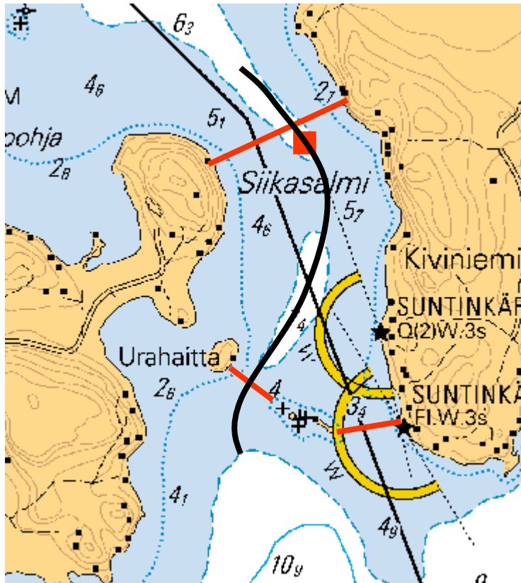
Kuva 1. Vesijärven Siikasalmi. Karttaan on merkitty salmeen asennetun automaattisen mittausaseman sijainti (Jyväskylän yliopiston ADCP) sekä veneeseen kiinnitetyllä virtausmittarilla (Helsingin yliopiston ADCP) ajetut linjat (punainen väri). Lämpötilamittaukset (CTD –luotain) ovat pohjoisimmalta luotauslinjalta. (Lähde: Merikartta J Vesijärvi-Päijänne).
