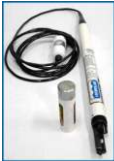
Kuva 6. CTD-luotain eli johtokyky-, lämpötila- ja syvyysluotain (Hydrolab Minisonde 4a).
